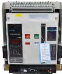
CFW45/CFW1系列双电源自动转换开关，主要由两台CFW45或CFW1或CFW3万能式断路器、机械联锁及双电源转换控制器等组成。适用于50Hz 额定工作电压400V的两路三相四线制电网中。对供电的两路电源的三相电压同时检测，当任意一相发生过压、欠压(包括缺相)，即自动从异常电源切换到正常电源；用于电网发电系统的产品还能发出发电和卸载信号，是一种性能完善、安全可靠、自动化程度高、使用范围广的双电源自动切换产品。
