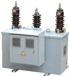
JLSZW10-6、10kV干式、宽负荷、防盗电三相三线电力计量箱为环氧树脂浇注绝缘，外装经防腐处理的钢箱结构，产品可做单、双电流比，0.2S级的高精度保证宽负荷下准确计量，特殊材料保证低安压下产品的精度可获得大的动热稳定倍数。产品为积木式，可单个电流或电压部分更换。
